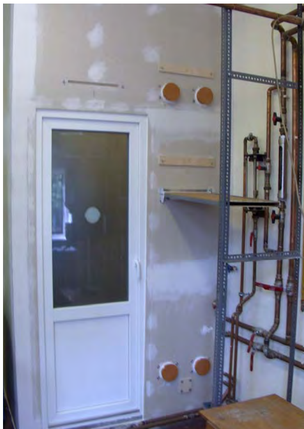
A mérőkamra a műanyag nyílászáróval
